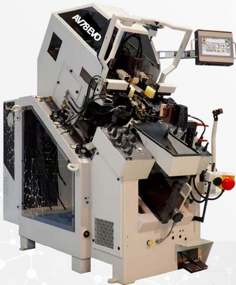
Macchina premontatrice montatrice, programmabile, elettronica, oleodinamica, 9 pinze indipendenti.
