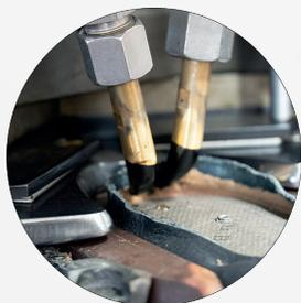
Spalmatura del collante termoplastico direttamente sul sottopiede
