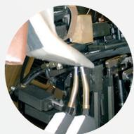
Due tracciatori mobili per la totale distribuzione del collante termoplastico su qualsiasi tipo di scarpa ed in qualsiasi misura
