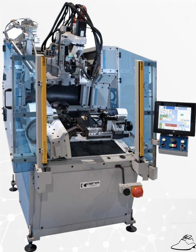
Macchina per l'incollaggio laterale della calzatura.
