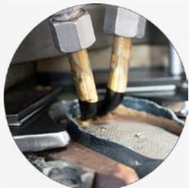
Spalmatura del collante termoplastico direttamente sul sottopiede
