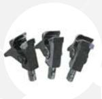
Sostituzione ad innesto rapido delle 3 pinze di punta.
