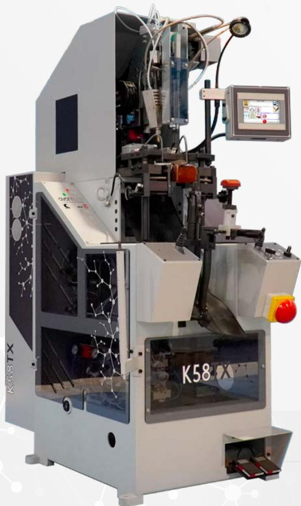
La K58TX nasce come naturale evoluzione della storica macchina K58STI. Il sistema di spalmatura di collante termoplastico direttamente sul sottopiede avviene tramite tracciatori.
